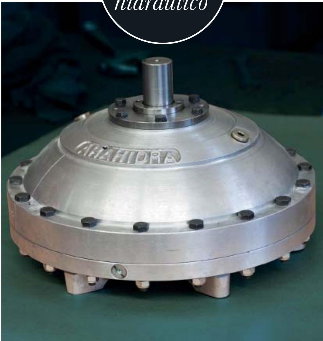
*«El acoplador hidráulico transmite el par de un árbol o eje motor a otro únicamente por acciones de contacto hidrodinámico. Evitando así la conexión mecánica entre ellos, sin contacto de elementos rígidos o elásticos.»*
