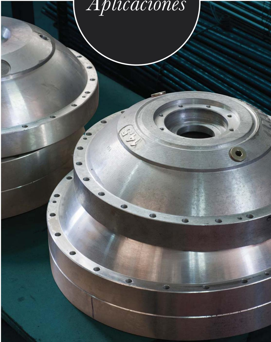
*El acoplador hidráulico ha contribuido eficazmente a poder generalizar en multitud de aplicaciones el empleo de motores con arranque directo, los más simples, seguros y de menor coste en el mercado.*
