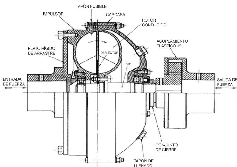
De esta manera, los acopladores hidráulicos sirven también para limitar el par máximo aplicado a todas aquellas máquinas que estén expuestas a calados bruscos.
